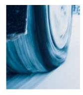
mit zusätzlichen Lamellen. Während ein PKW auf schneebedeckter Straße mit Sommerreifen aus nur 50km/h erst nach 43 Metern zum Stehen kommt, reichen einem PKW mit Winterreifen 35 Meter zum Stillstand!
