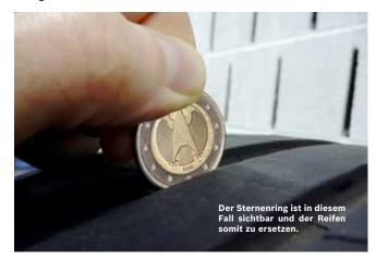
Spätestens nach 10 Jahren sollte der Reifen erneuert werden (auch wenn das Profil noch ausreichend ist). Das Alter Ihres Reifens erkennen Sie an der aufgedruckten **DOT-Nummer** (vierstellig): Die letzten beiden Ziffern stehen für das Produktionsjahr und die ersten Beiden für die Produktionswoche (2600 bedeutet also 26. Woche im Jahr 2000).
